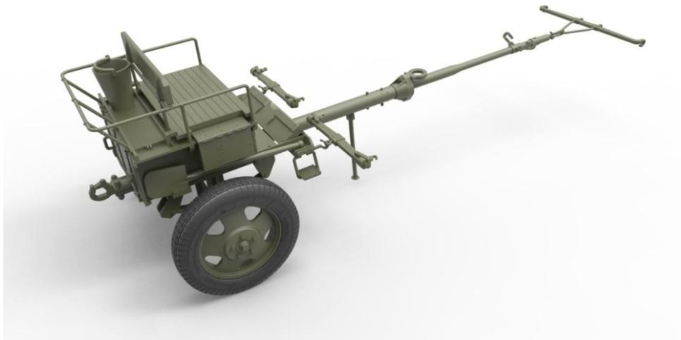
Артиллерийский передок для 45-мм. противотанковой пушки
