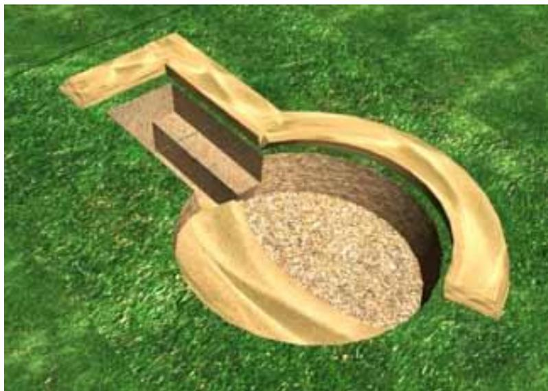
На снимке макет орудийного окопа с аппарелью и ровиком с левой стороны.
